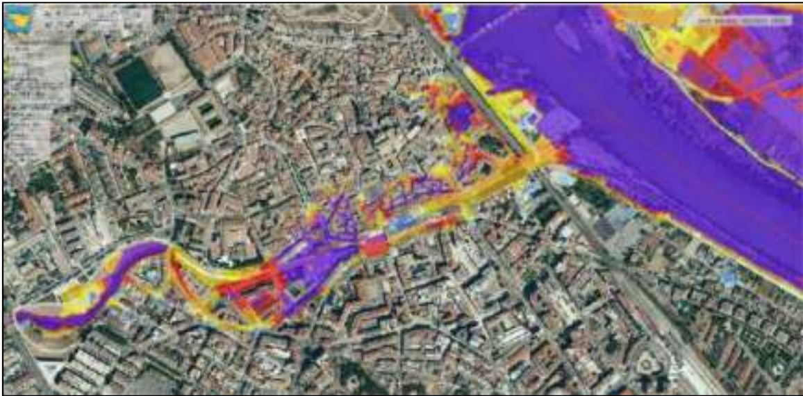
Ilustración 33. Ejemplo de Mapa de Peligrosidad asociada a calados, disponible en el visor del segundo ciclo de la CHE. El ejemplo muestra el Mapa de Peligrosidad para T=100 años, en concreto en detalle de los calados esperables en el casco antiguo de la localidad.
