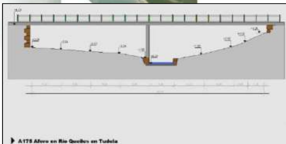
Ilustración 15. Esquema de medición de la sección de la estación de aforo de la CHE en el río Queiles en Tudela.
