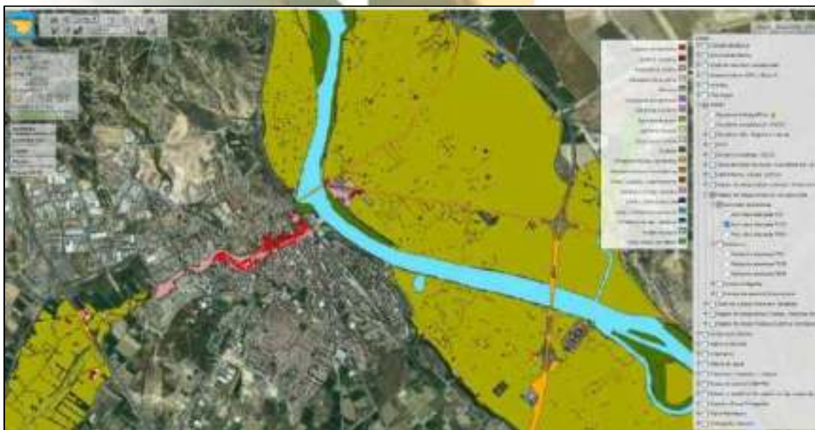
Ilustración 35. Mapa de Riesgos para las actividades económicas de la zona del río Ebro en el entorno del casco urbano de Tudela. Las imágenes muestran las afecciones de una avenida esperable cada 100 años, obtenida del visor del SNCZI. Información del primer ciclo de la directiva.
