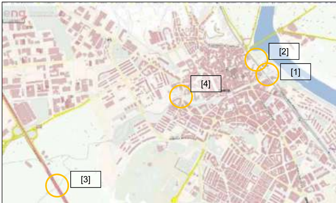
Ilustración 25. Localización de los 4 puntos principales que pueden suponer un obstáculo significativo o crítico para la circulación del agua desbordada en Tudela. Puntos mostrados sobre el mapa base disponible en IDENA.
